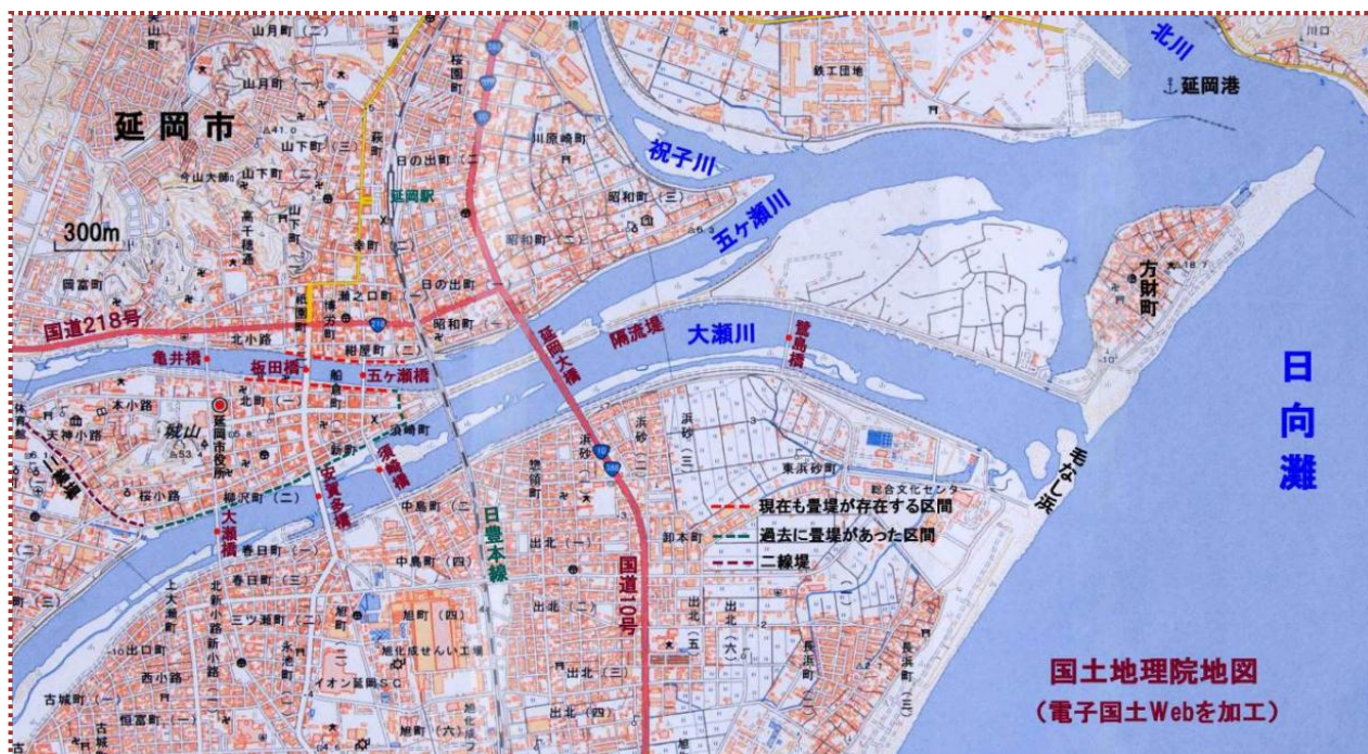
図-2 現在は隔流堤によって五ヶ瀬川と大瀬川が分離されている
